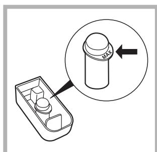
Tegye be a 4-es berakható tartályt az 1-es rekeszbe. A fehérítőszer betöltése közben vigyázzon arra, hogy az a központi csapon jelzett "max" szintet ne haladja meg (lásd ábra).
